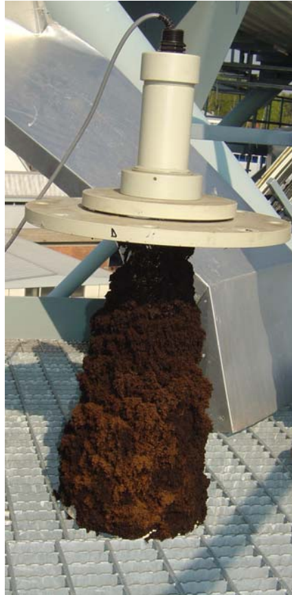
Kuva 1: Turve tarttuu anturin ulkopinnalle sienimäiseksi kakuksi.
